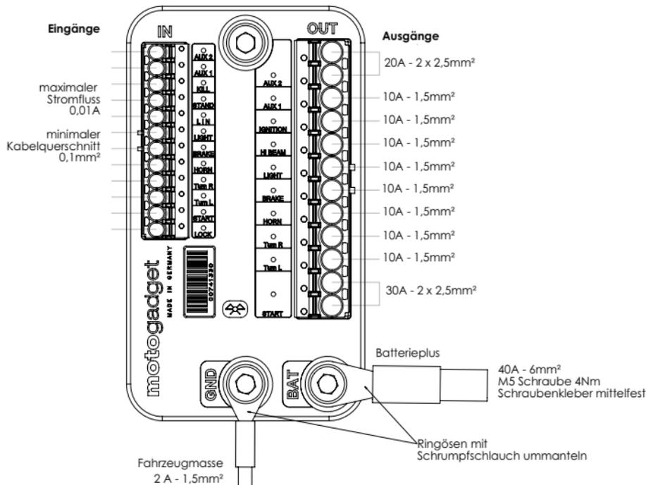
Alle Anschlusskabel müssen knickfrei, zugentlastet und gut isoliert verlegt werden. Zur Verlegung und Befestigung der Kabel empfehlen wir Kabelbinder aus Kunststoff.
